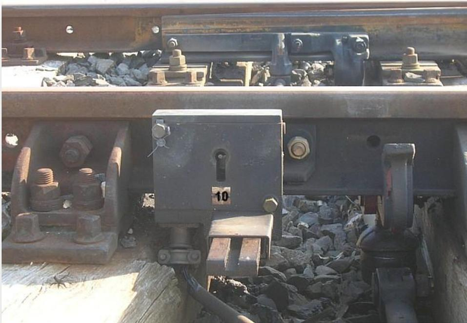
*Inserendo e girando la chiave 10 nel fermascambio del deviatoio 6, possiamo manovrare anche quest'ultimo deviatoio: anche in questo caso, infatti, ruotando la chiave 10 nel fermascambio, viene tolto il perno dalla staffa.*
